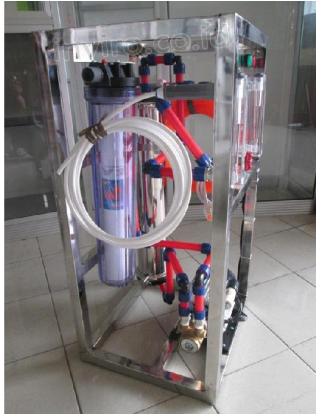
Gambar item no. 1 diatas, Unit Rangkaian Mesin RO (Reverse Osmosis) 1.000 GPD Vontron/CSM (Kapasitas Produksi Setara 200 Galon / Hari , 1 Galon = 19 Liter)
