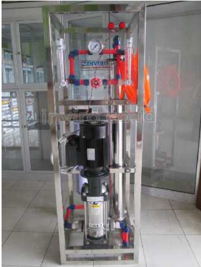
Gambar item no. 1 diatas, Unit Mesin RO (Reverse Osmosis) 2.000 GPD CSM CNP (Kapasitas Produksi Setara 400 Gallon /Hari, 1 Gallon = 19 Liter)
