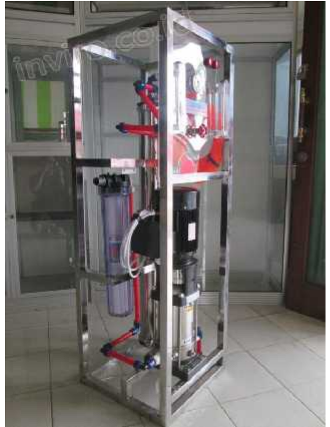
Gambar item no. 1 diatas, Unit Mesin RO (Reverse Osmosis) 2.000 GPD CSM CNP (Kapasitas Produksi Setara 400 Gallon /Hari, 1 Gallon = 19 Liter)
