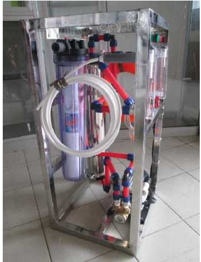
Gambar item no. 1 diatas, Unit Rangkaian Mesin RO (Reverse Osmosis) 1.000 GPD CSM Procon / RotoFlow (Kapasitas Produksi Setara 200 Galon / Hari, 1 Galon = 19 Liter)
